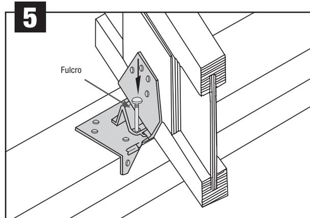
Deslice el fulcro apretado bajo el hueco del cabrio y asegure con (2) clavos 10d (0.148" x 3"). En este punto, deben estar llenos todos los agujeros de clavos.
