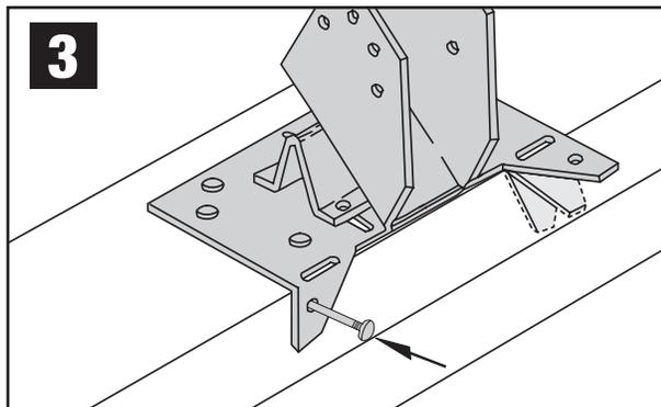
Doble hacia abajo las lengüetas contra el borde de la placa superior. Sujete con (2) clavos 10d (0.148" x 3").
