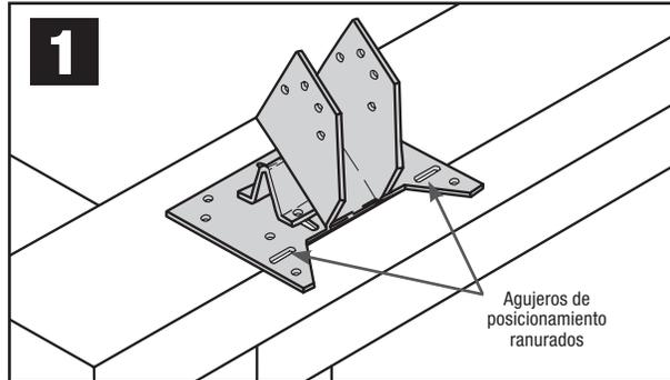
Posicione el conector sobre la placa superior. Centre el borde exterior de la placa superior en los agujeros de posicionamiento ranurados.
