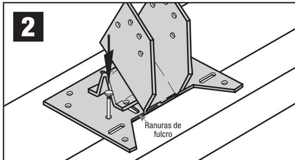
Sujete el conector a la parte superior de la placa superior con (6) clavos 10d (0.148" x 3"). **NOTA:** No instale los clavos a través de las ranuras de fulcro o punto de apoyo todavía.
