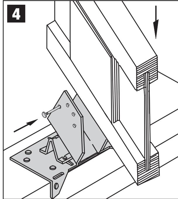
Inserte el cabrio en el hueco para el mismo. Ejerza presión hacia abajo para asentar totalmente el cabrio. Sujete el cabrio al hueco del mismo con (8) clavos 10d (0.148" x 1-1/2 pulg).
